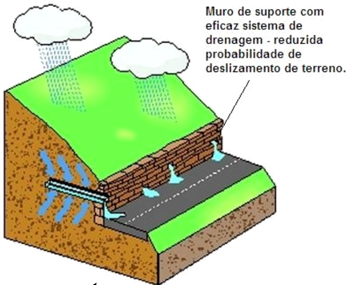
Muros de suporte Canais de drenagem
