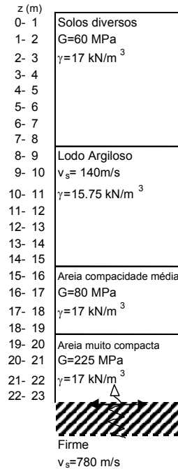
Figura 64 – Lugar da Ota: Perfil geotécnico simplificado H (sondagem SP19)
