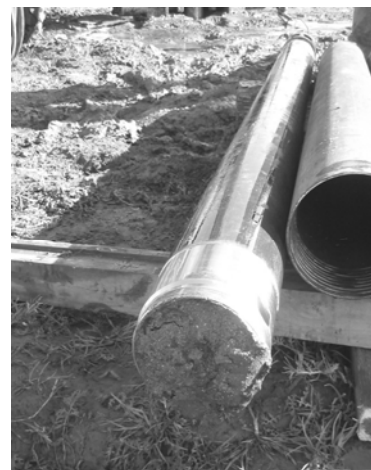
Figure 3 – Pormenor do amostrador Geobor S
