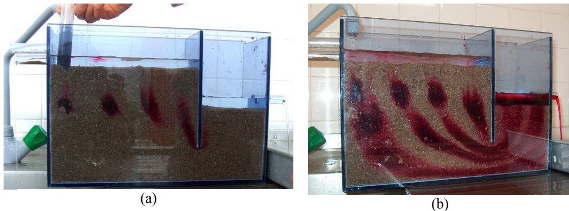
Figura 1 - a) Injecção do corante; b) Visualização de linhas de percolação
