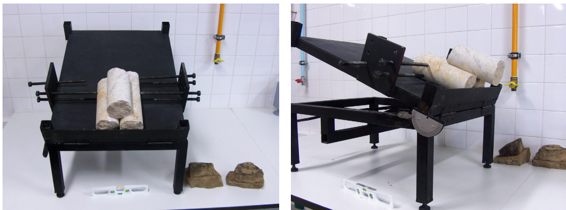
Figura 3 - Ensaio com tarolos de sondagem
