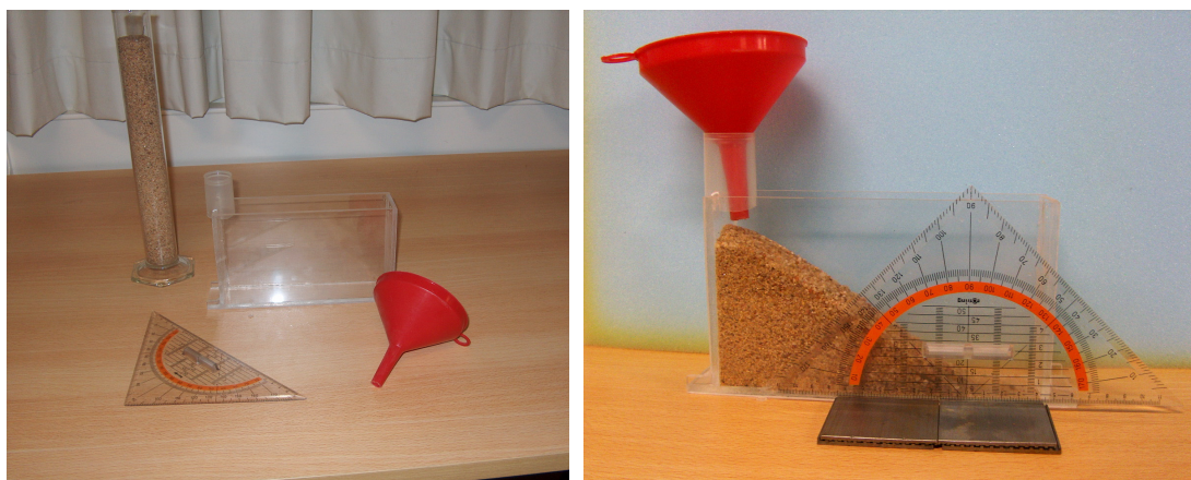
Figura 4 - Medição da inclinação do talude formado pela areia
