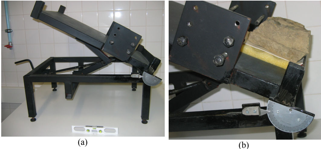
Figura 2 – a) Dispositivo de Tilt-Test . b) Ensaio de descontinuidade natural
