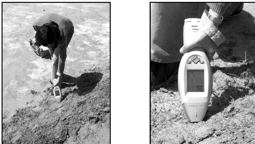
Figura 2 – Utilização do analisador FRX in situ .
