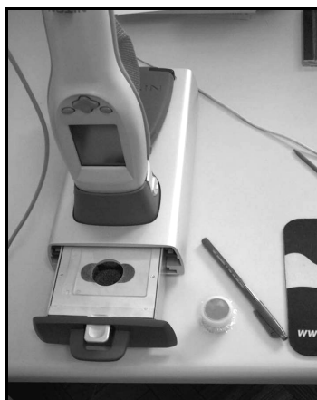
Figura 3 – Ensaio ex situ , realizado no dispositivo em chumbo.
