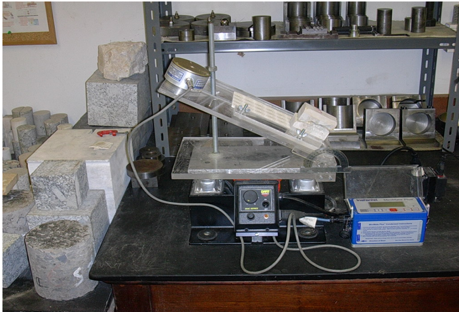
Figura 8 - Modelo de instabilização de bloco calcário sobre diaclase, com medição de vibrações
