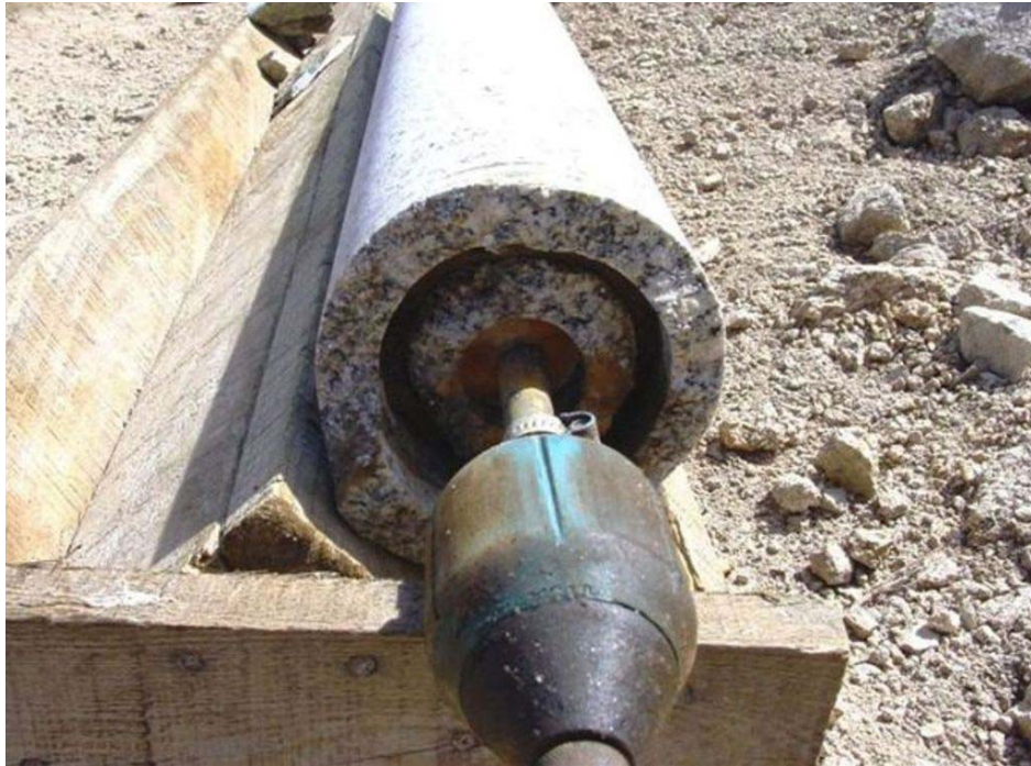
Figura 8 – Efeito da sapata \varnothing 113 mm no testemunho \varnothing 123 mm
