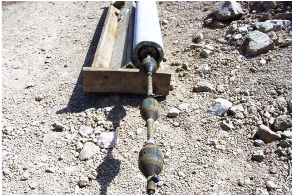
Figura 10 – Testemunho \varnothing 123 mm com a célula STT e varas de ligação
