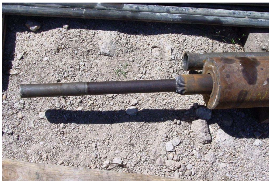
Figura 2 – Caroteiro \varnothing 36 mm colocado no centralizador
