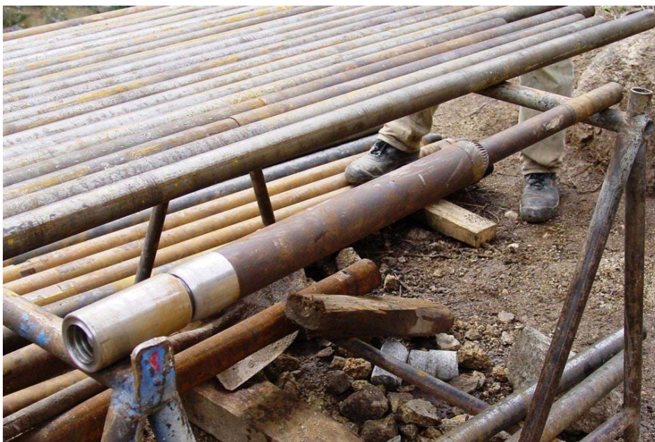
Figura 5 – Caroteiro \varnothing 36 mm adaptado no caroteiro \varnothing 56 mm
