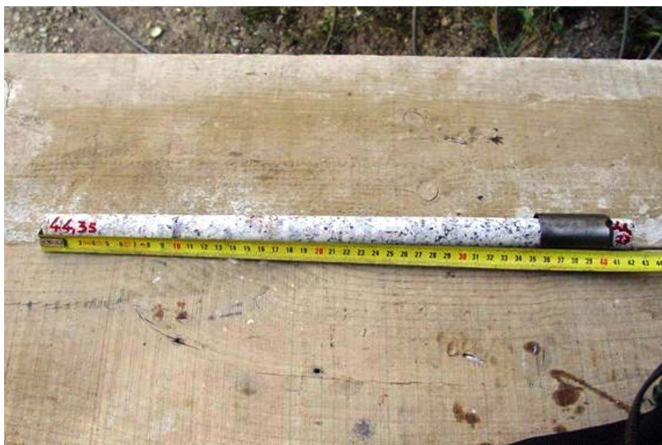
Figura 3 – Testemunho recuperado com o caroteiro \varnothing 36 mm
