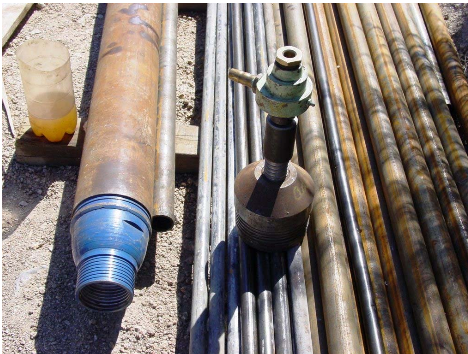
Figura 9 – Cabeça do caroteiro e de adução de água.
