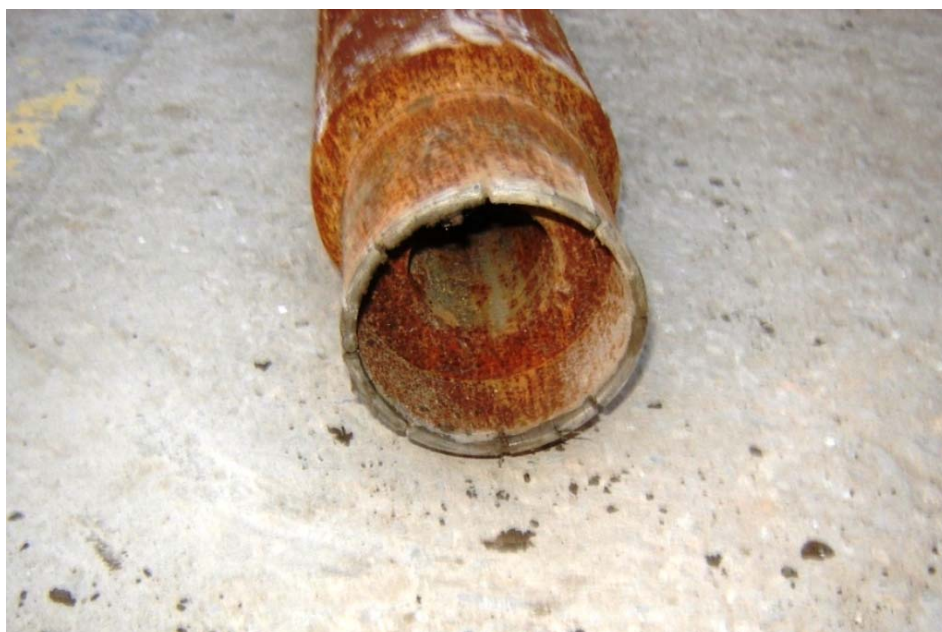
Figura 7 – Sapata \varnothing 113 mm adaptada ao centralizador \varnothing 146 mm
